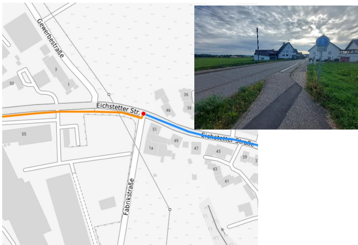
Abbildung 6-10: Beispiel Fahrbahneinengung im Ortseingang (L116) Neuershausen (MCH019_L_1)
