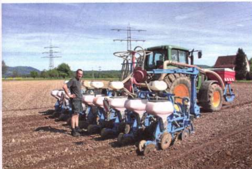
Maissägerät mit der Möglichkeit der Mikrogranulat- und Unterfußdüngung. Der Dünger wird unmittelbar neben dem Saatkorn abgelegt und steht dem Saatkorn direkt zur Verfügung. Fotos: Sprich
