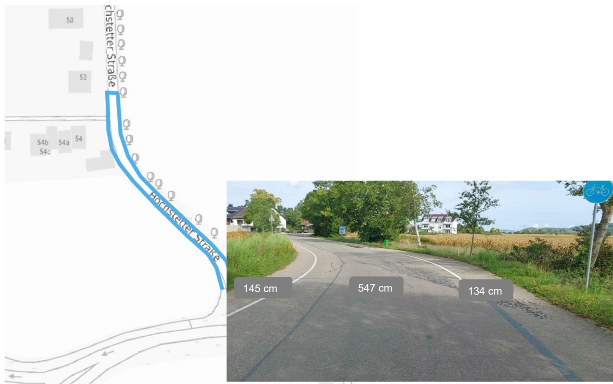
Abbildung 6-8: Beispiel Maßnahmentyp Schutzstreifen BAR056_G (Hochstetter Straße)
